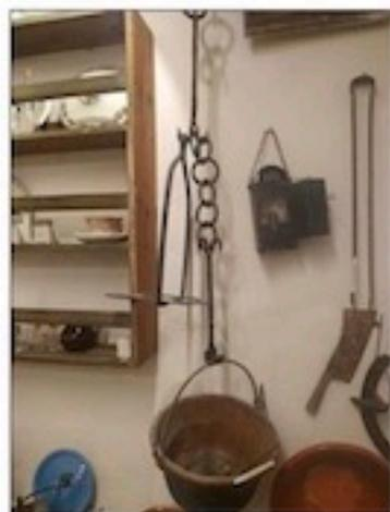
La crémaillère est un dispositif mécanique qu'on accrochait au dessus de l'âtre, et qui permettait de suspendre des chaudrons (*peiroulet*), des bouilloires, tout récipient pourvu d'une anse. Les anneaux de la chaîne servaient à régler la température de cuisson, en permettant au contenant d'être plus ou moins proche du feu.
