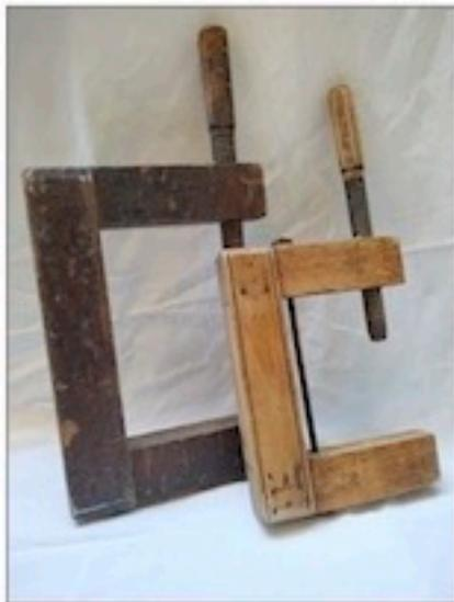
Le serre-joint était et est encore utilisé pour maintenir en place une ou plusieurs pièces de bois, afin de pouvoir les visser ensemble, les coller, poser des chevilles, etc...
