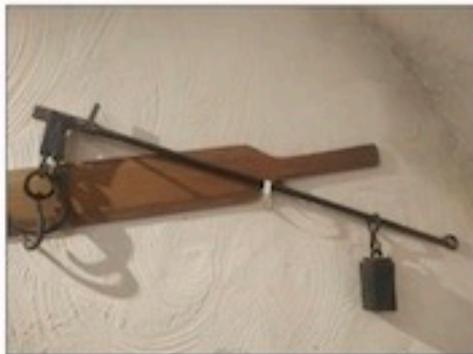
Contrairement à ce que son nom indique, cette balance vient de Chine. Elle est composée d'une barre horizontale, accroché d'un côté à une barre verticale. Sur le bras le plus court est suspendu un bassin, ou un crochet servant à soutenir l'objet à peser. De l'autre côté, le bras est gradué, et on peut y faire coulisser un poids. Pour peser un objet, on l'accroche du côté du bras le plus court, et on cherche à atteindre l'équilibre en faisant glisser le poids mobile, et donc en essayant
