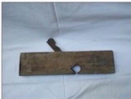
Le rabot est utilisé pour aplanir le bois, y creuser des moulures ou des rainures. Il est composé d'un corps principal appelé le fût, percé d'un espace, la lumière, sur la partie inférieure. Dans cet espace s'emboîte un fer biseauté et affuté, qui dépasse légèrement de la semelle du fût. On peut ajuster la longueur dépassante, de manière à ce qu'elle puisse faire quelques
